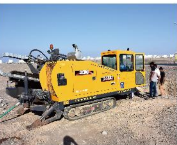
XZ200水平定向钻机在阿曼施工 XZ200 HDD working in Oman
